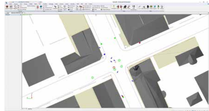
Kopplingen mellan Topocad och EspeCity är dubbelriktad och innehåller funktioner för att digitaliserade objekt i EspeCity landar direkt i Topocad.
